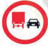
ممنوع التجاوز للشاحنات OVERTAKING BY TRUCKS PROHIBITED
